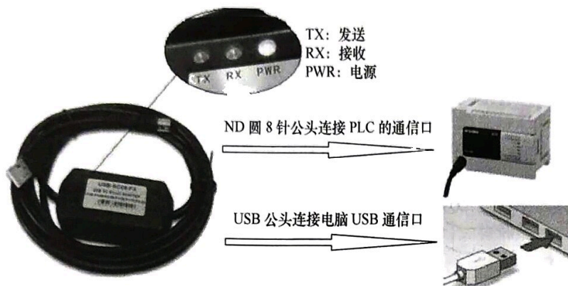
(b) 计算机侧为 USB 口的连接方式
